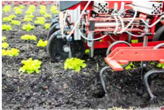
Pflanzenschutzroboter mit Spot-Spraying-Technologie.
